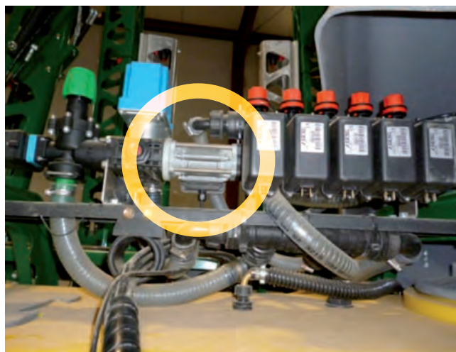
Figura 20. Caudalímetro aforador instalado en una barra de aplicación preparada para la dosificación variable de abono líquido
