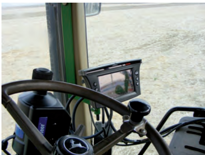
Figura 25. Sistema de ayuda al guiado mediante barra de luces, arriba, y monitor de rendimiento, abajo, montado en cosechadora
