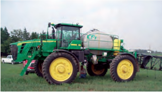
Figura 18. Sistema de aplicación de abono líquido variable autocorregido con sensor hiperspectral "Greenseeker" que calcula el índice de verdor del cultivo (NDVI)
