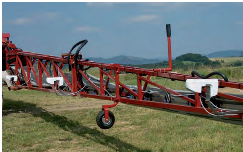
Figura 16. Sistema de montaje de greenseeker en barra de aplicación variable de abono líquido
