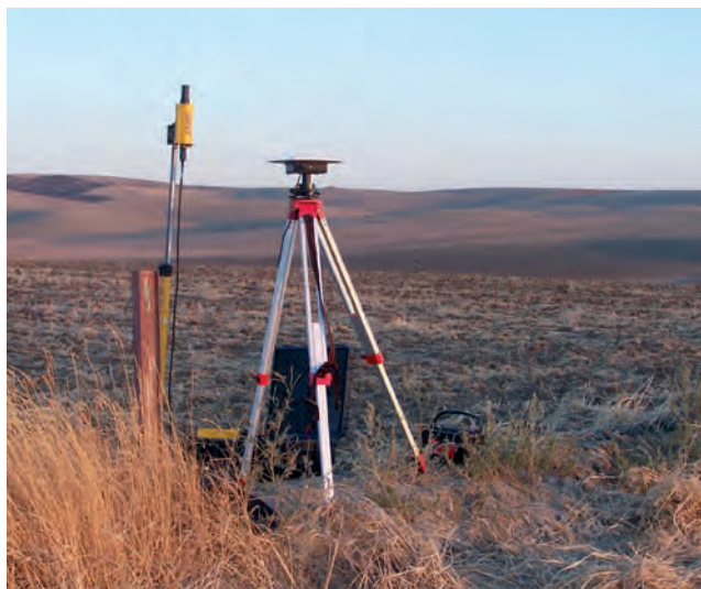
Figura 6. Estacion base para correcciones RTK
