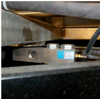
Figura 23. Célula de carga instalada en abonadora.
