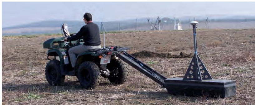
Figura 11 Sonda EM38 arrastrada por quad.
